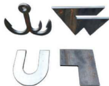
Échantillon de découpe au plasma
